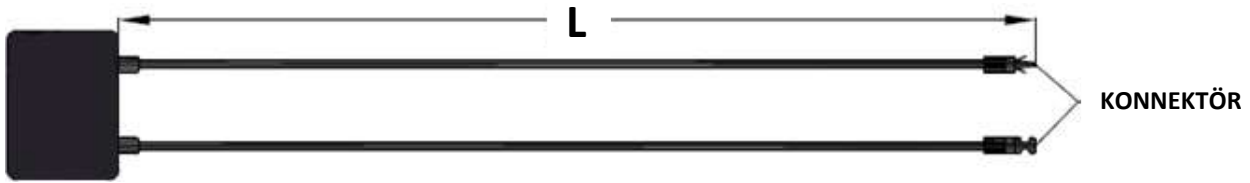
Şekil 6: Bağlantı Kutusu Kablosu
